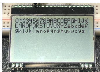
Abbildung 3.1: Das Display DOGM128W-6 auf einer Steckplatine.
